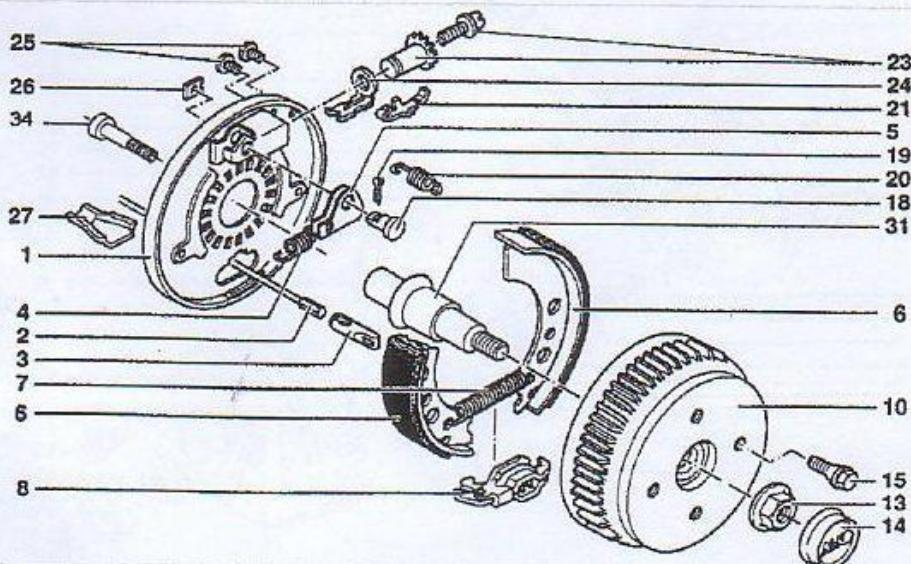
AL-KO - Freno Compact Tipo 2051 Carico per ruota 750 Kg - 811158
